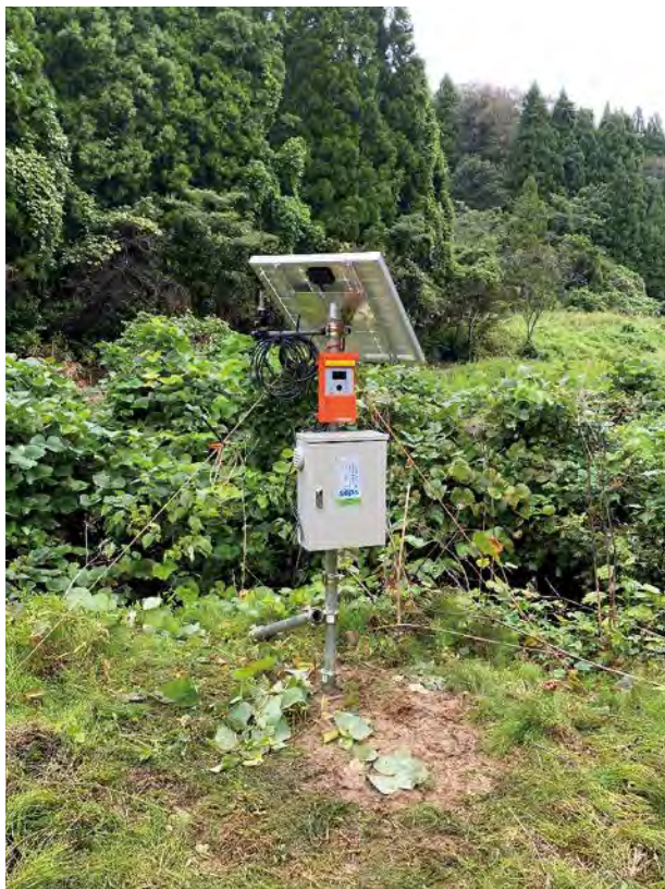
図-7 罠に設置した孫機の電波を受ける子機
